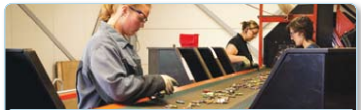
Medewerkers sorteren bepaalde typen batterijen uit de grote stroom.
